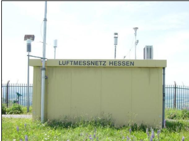
Abbildung 31: LUG-Station Wasserkuppe – Messcontainer.
