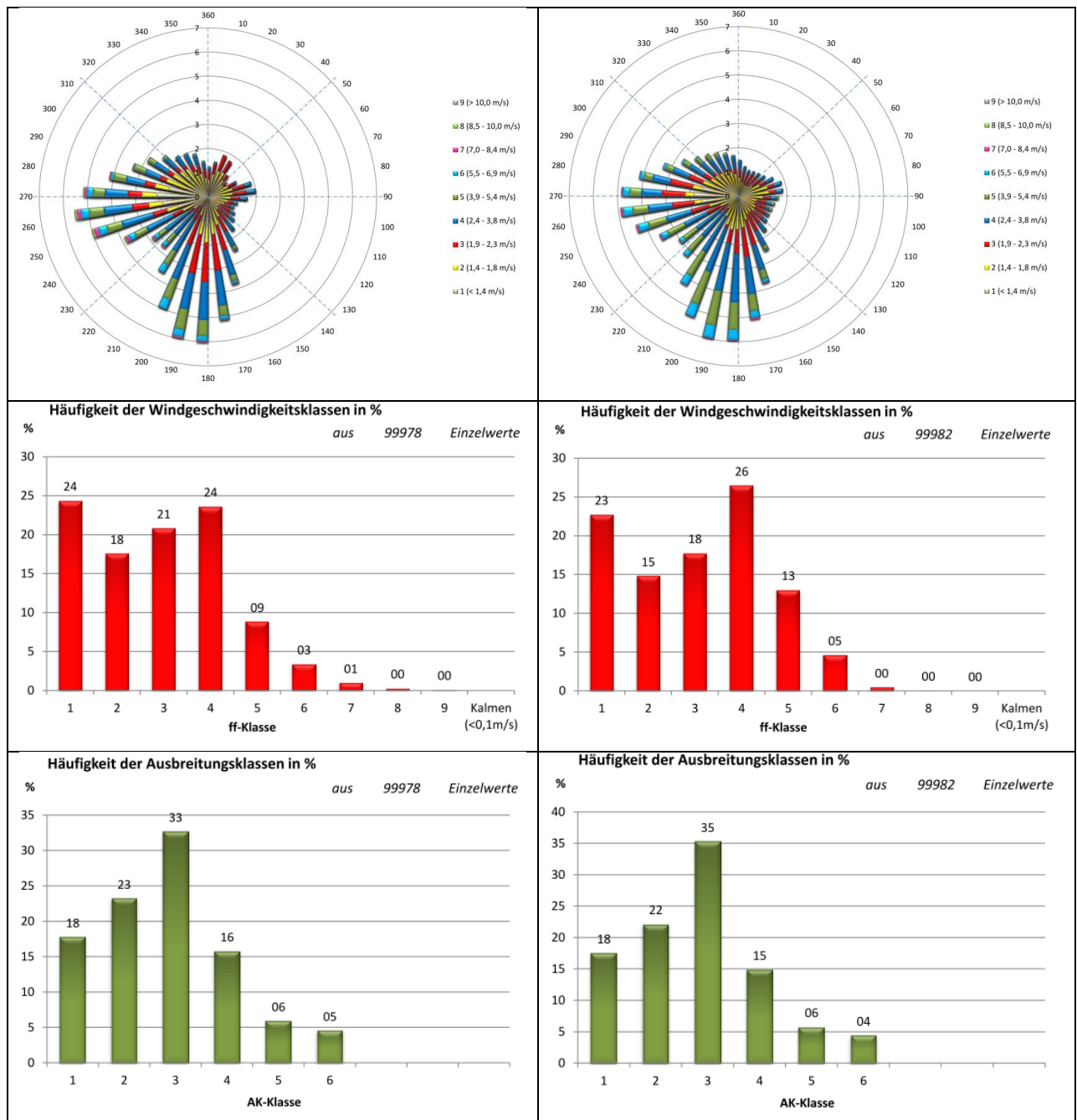
Abbildung 14: Windrosen und Häufigkeitsverteilungen von Windgeschwindigkeit und Ausbreitungsklasse an der GK-Koordinate 4419500 / 5442500, berechnet auf Basis von 120 Clustern (links) und 269 gleichverteilten Clustern (rechts).
